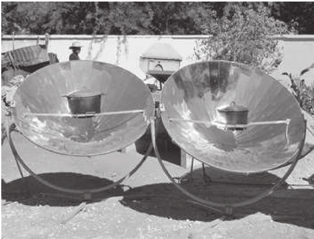
Fig. 8 : un cuiseur solaire parabolique capable de générer des températures très élevées. Source : Ecosun https://www.mediaterre.org/afrique-centrale/
