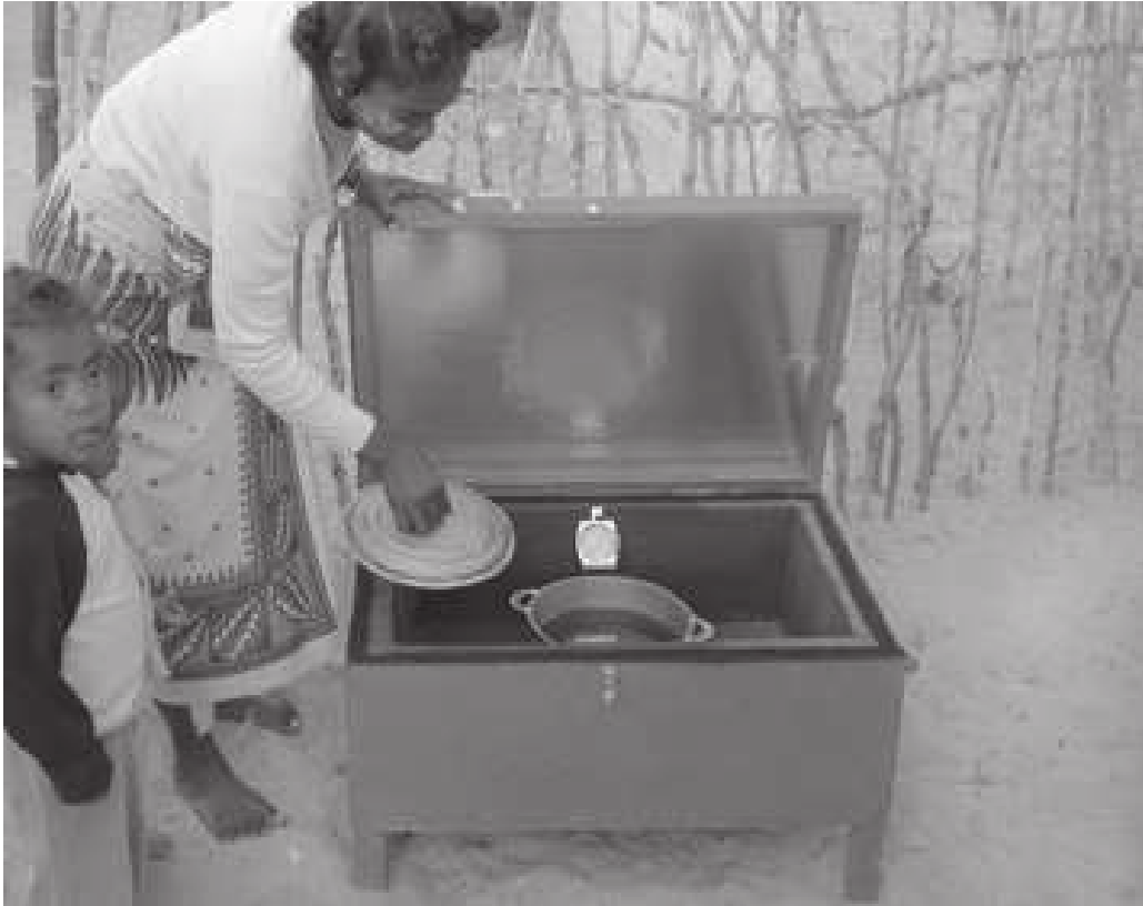
Fig. 7 : un four solaire boîte : la température atteint jusqu'à 150 °C
